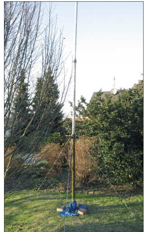
Bild 2: \lambda/4 -Vertikal für 40 m mit NVA-Mast
