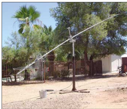
Die Antennen-/Elevationskonstruktion funktioniert. Ned hat damit von daheim in Arizona bereits Test-QSOs via Mond gefahren. Foto: AA7A
