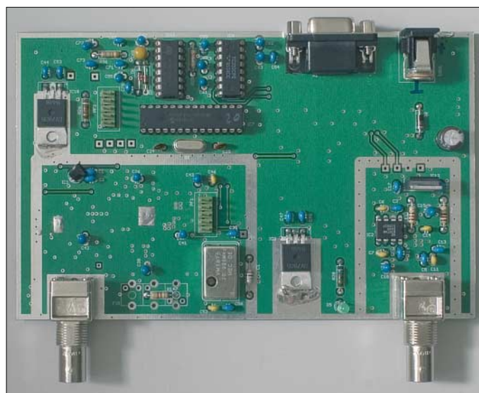
Bild 3: Bestückungsseite des Prototyps der Serienfertigung
